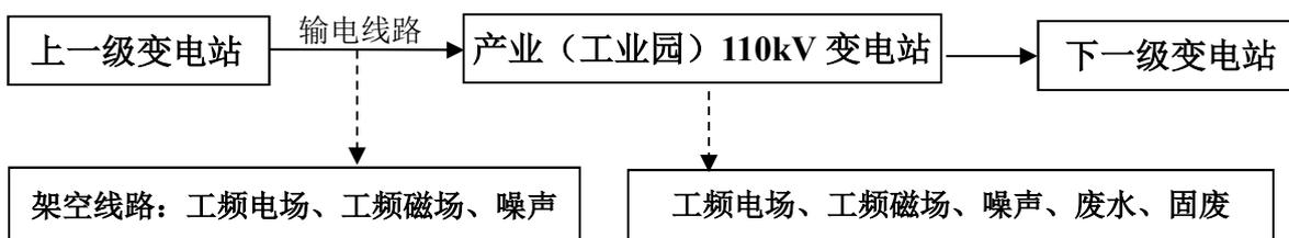
图 1 徐州产业（工业园）110kV 输变电工程工艺流程及产污环节示意图
