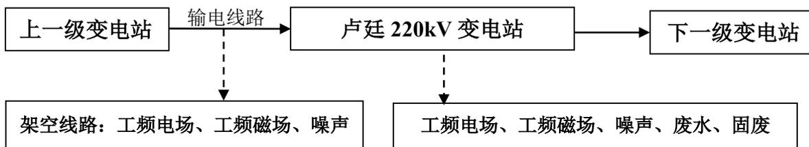
图 1 宿迁 220kV 卢廷输变电工程工艺流程及产污环节示意图
