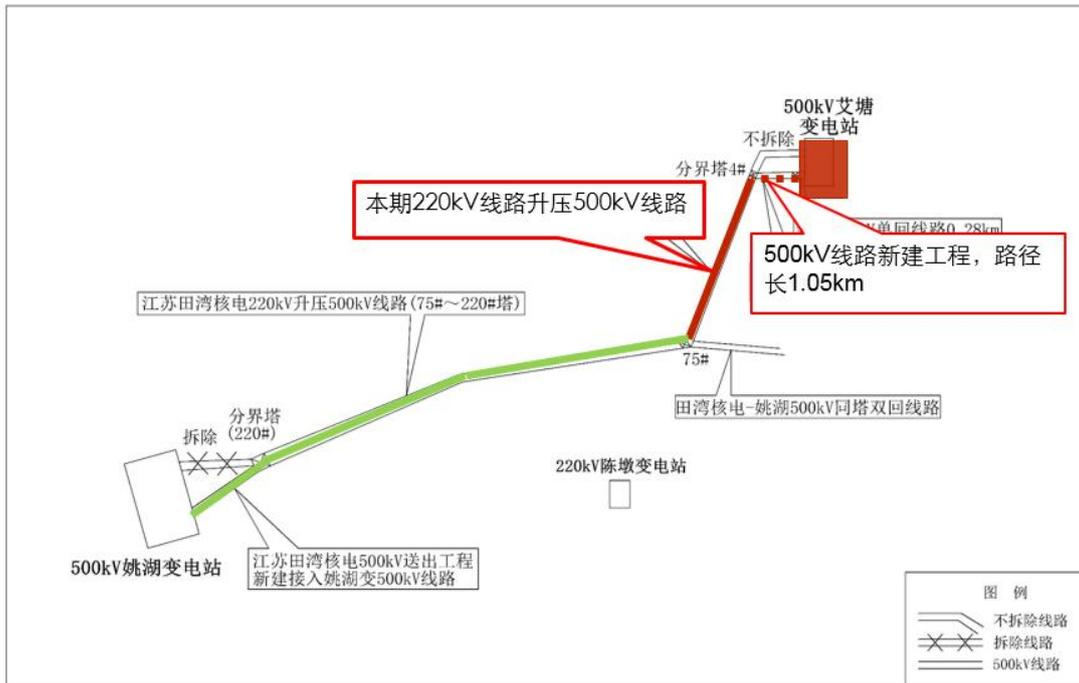
图 3.3-2 艾塘变~姚湖变 220kV 线路升压 500kV 线路的路径示意图
