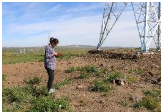
(内蒙段) GPS结合激光测距仪实地测量
