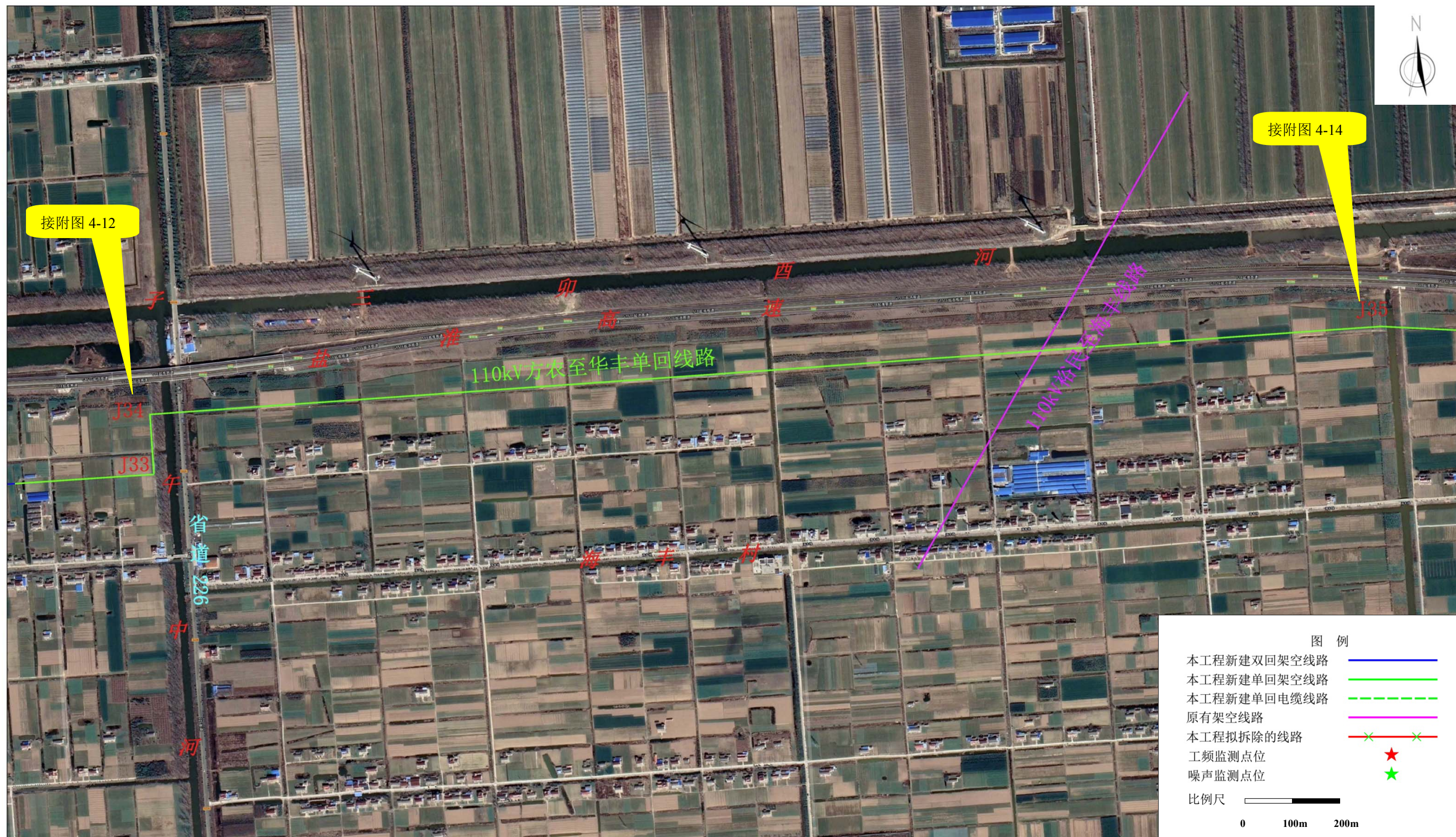
附图 4-13 江苏盐城大唐大丰三龙风电二期项目 110kV 送出工程输电线路路径及监测点位示意图
