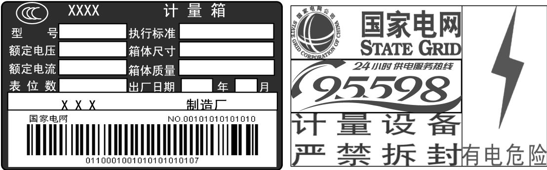
图 4 计量箱铭牌及标识型式示意图
