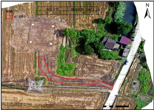
N7590 施工道路区扰动面积解译图-6 月
