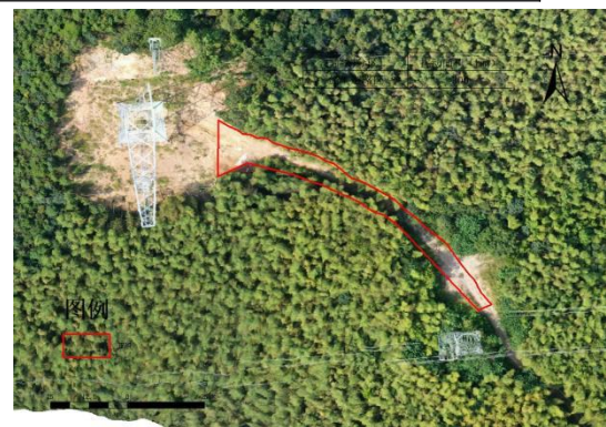
N7478 施工道路区扰动面积解译图-9 月
