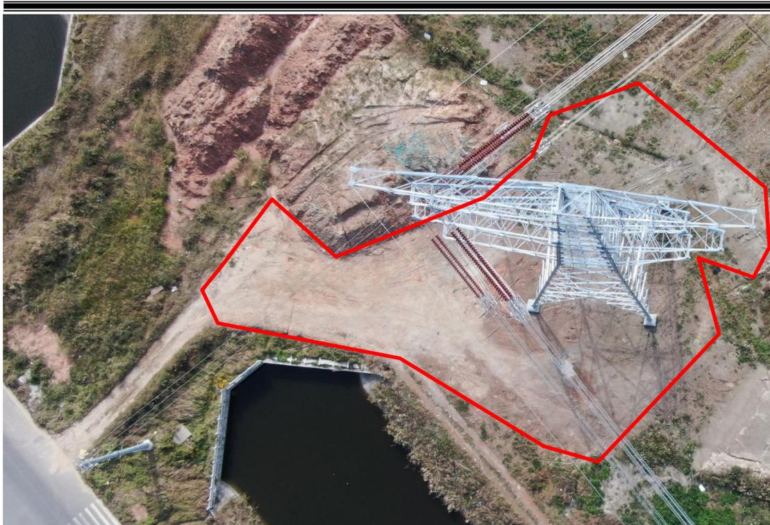
N26 塔基及塔基施工区扰动面积解译图-10 月
