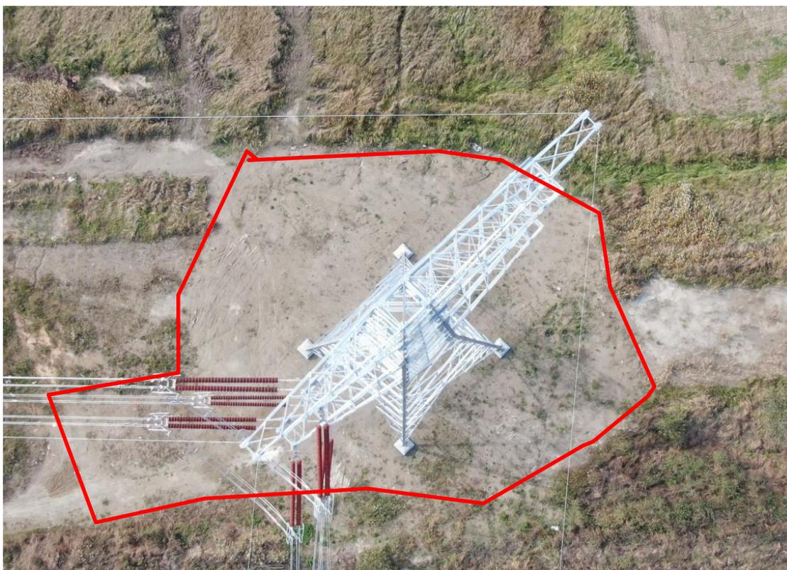
N26 塔基及塔基施工区扰动面积解译图-10 月
