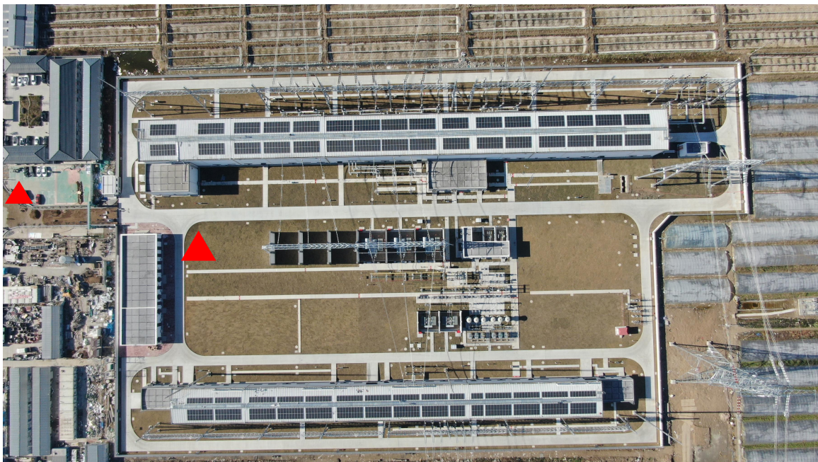
图 3-7 变电站工程监测点位布设图
