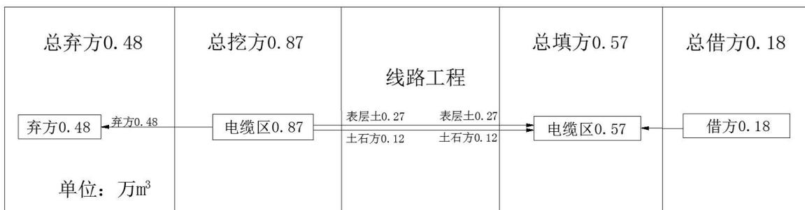
图1.3-1 土石方平衡流向图
