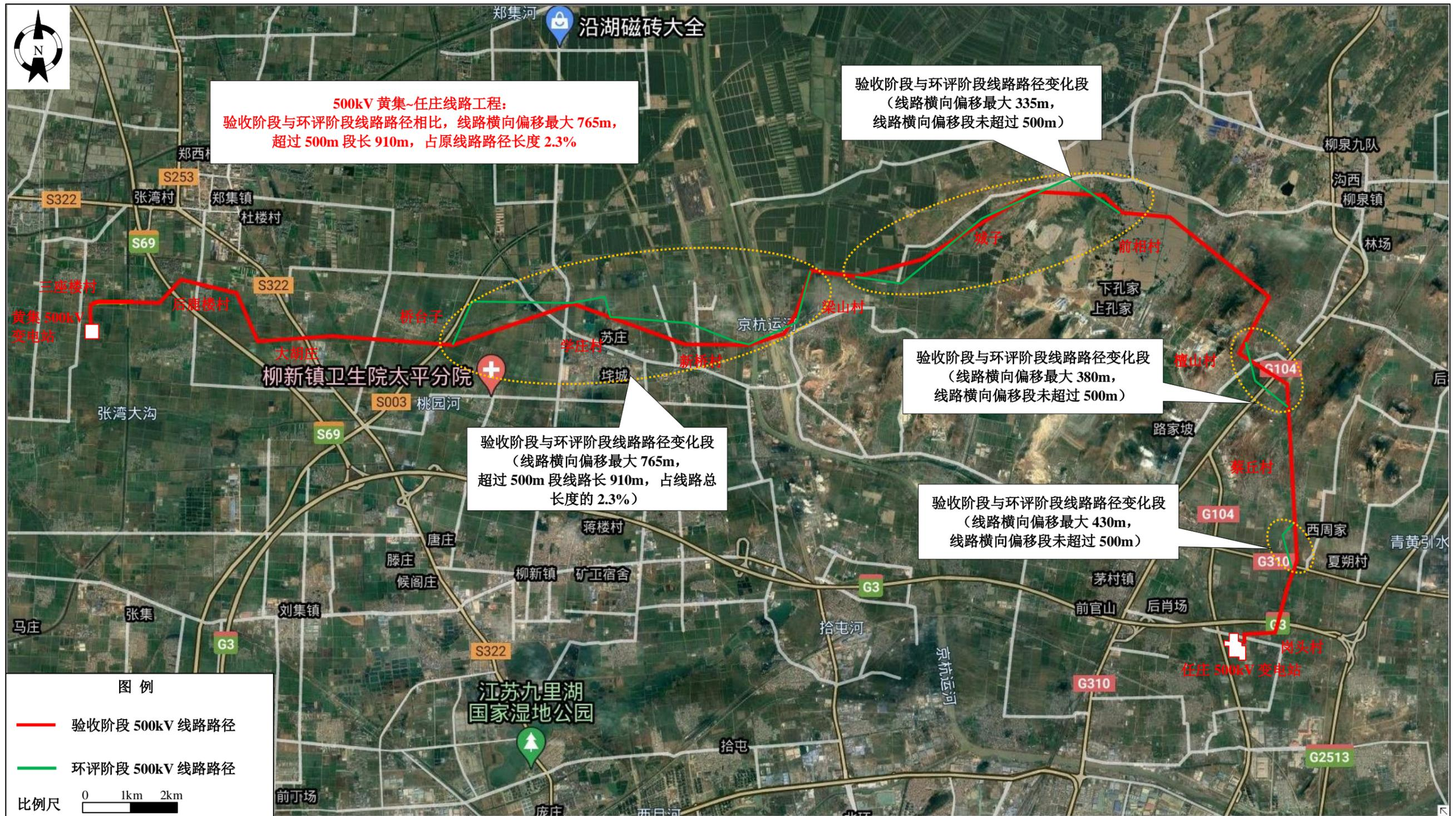
图 3-14 500kV 黄集~任庄线路环评阶段与验收阶段线路路径对比图
