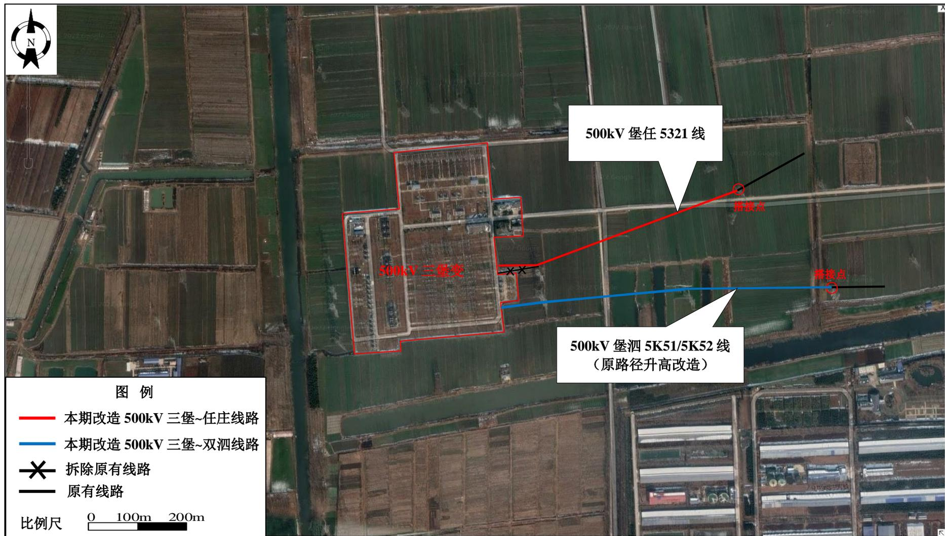
图 3-11 500kV 黄集~三堡线路工程线路路径图 (c)
