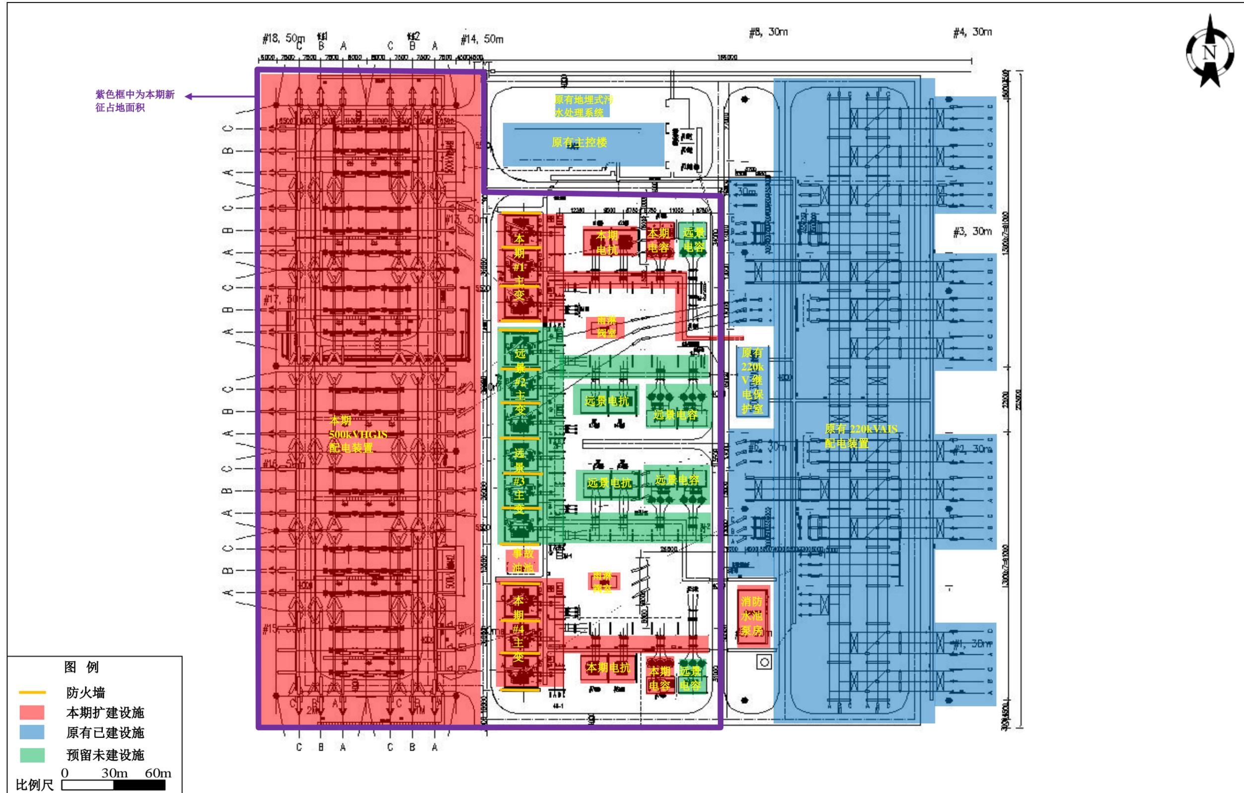
图 3-4 黄集 500kV 变电站总平面布置图
