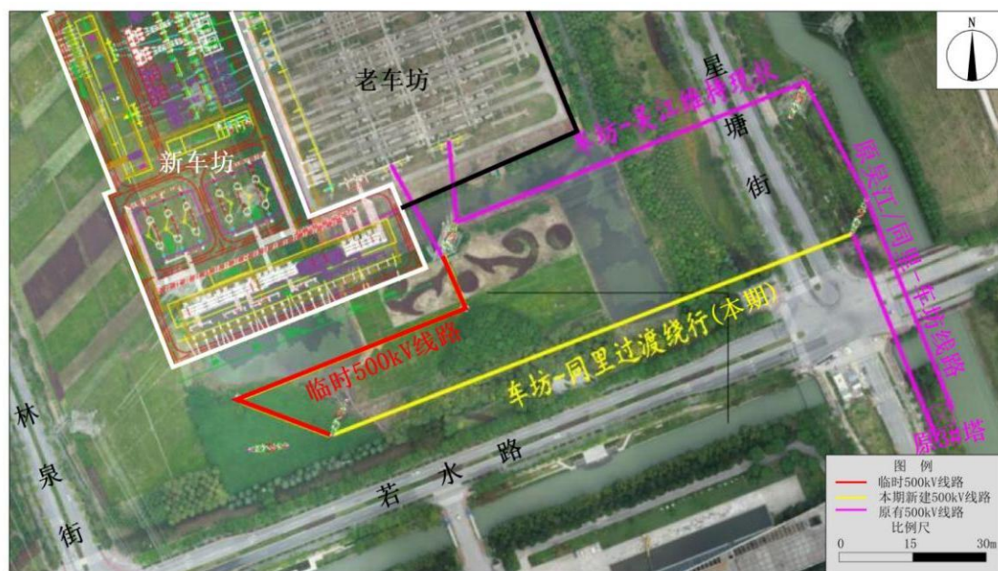
图 3.19 (a) 临时 500kV 过渡线路建设方案施工示意图
