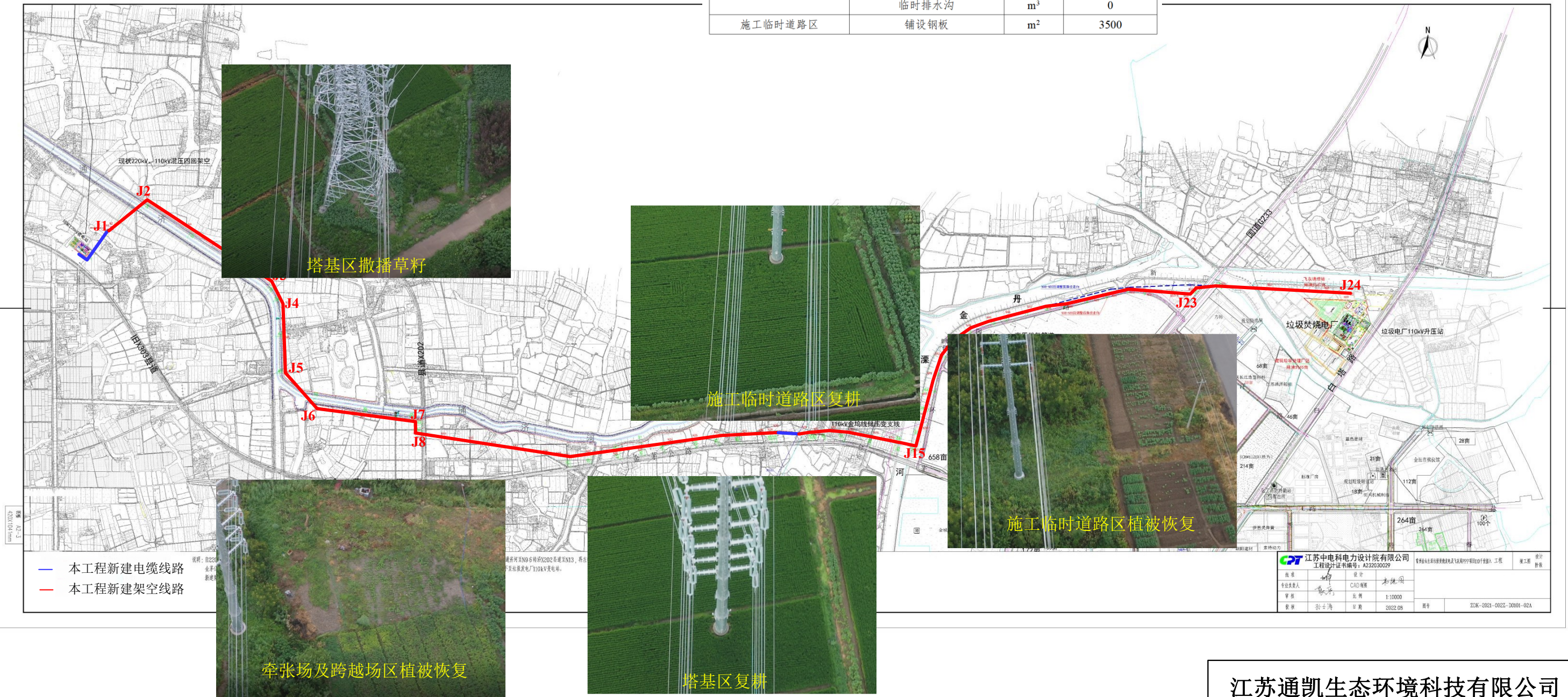
防治分区 措施内容 单位 工程量实施情况 塔基区 表土剥离 m 3 5856 土地整治 m 2 19147 牵张场及跨越场区 土地整治 m 2 7860 电缆施工区 表土剥离 m 3 598 土地整治 m 2 1870 施工临时道路区 土地整治 m 2 4000
