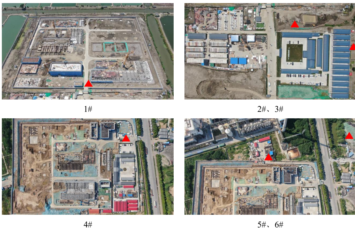
图 3-5 变电站工程监测点位布设图
