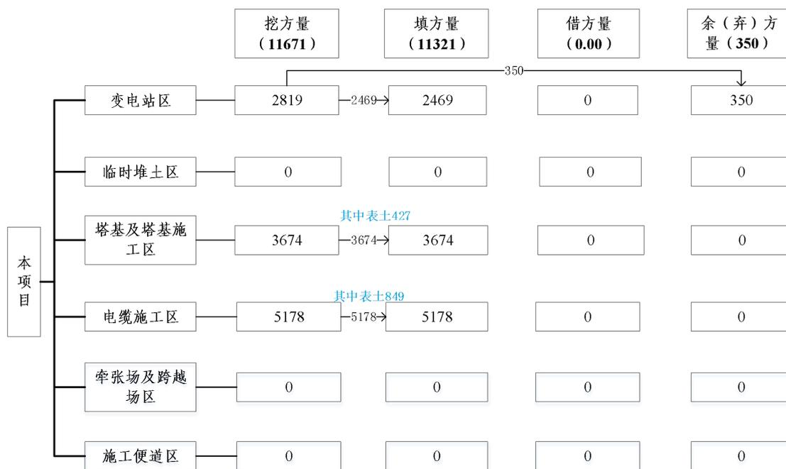
图 1.1-11 土石方挖填平衡流向框图 (单位: m<sup>3</sup>)
