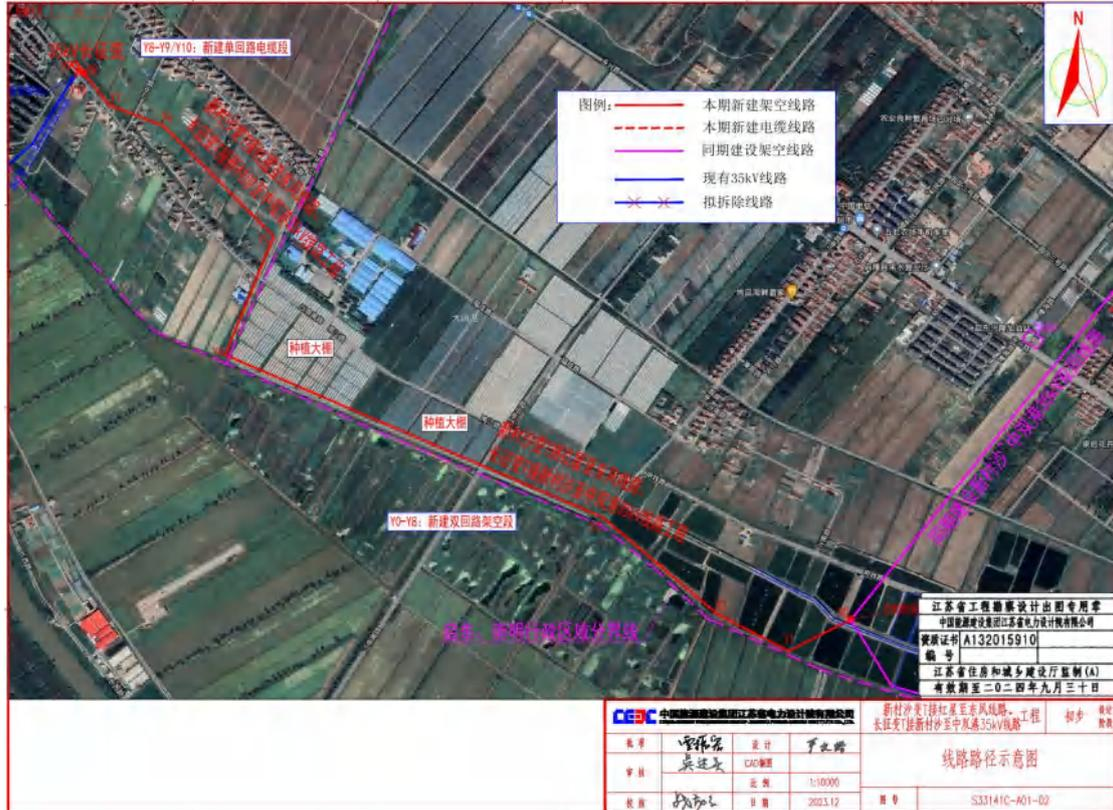
图 1.1-5 新村沙变 T 接红星至东风线路、长征变 T 接新村沙至中双港线路工程路径示意图
