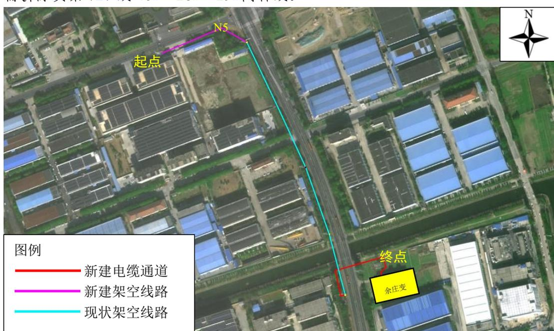
图 1.1-5 黄桥~余庄~小庄~横巷 110 千伏线路（第三部分）路径示意图
