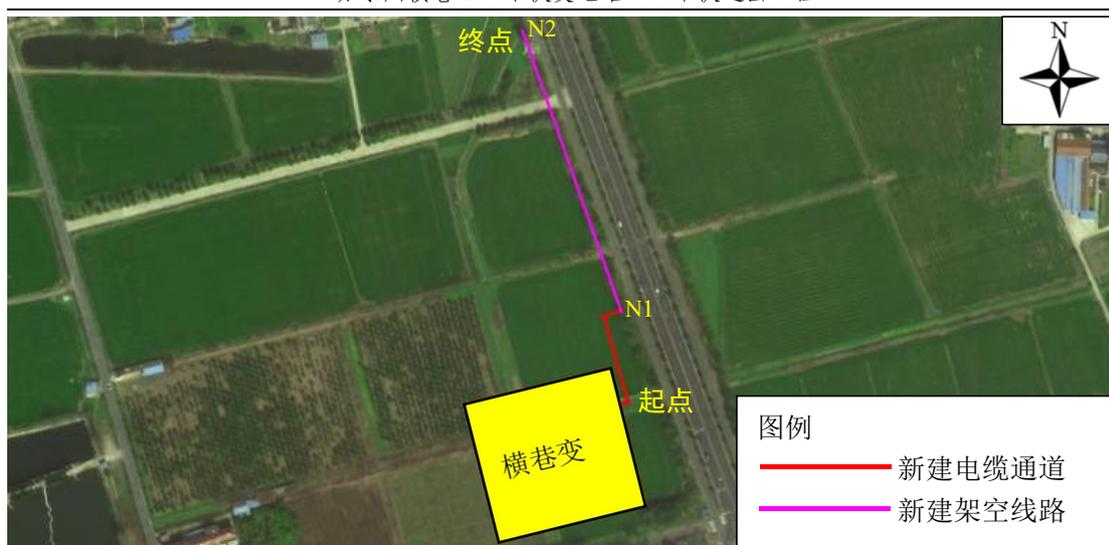
图 1.1-3 黄桥~余庄~小庄~横巷 110 千伏线路（第一部分）路径示意图
