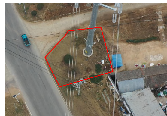
神山~沐东 21#塔基区 土地整治后撒播草籽 (2024 年 12 月)
