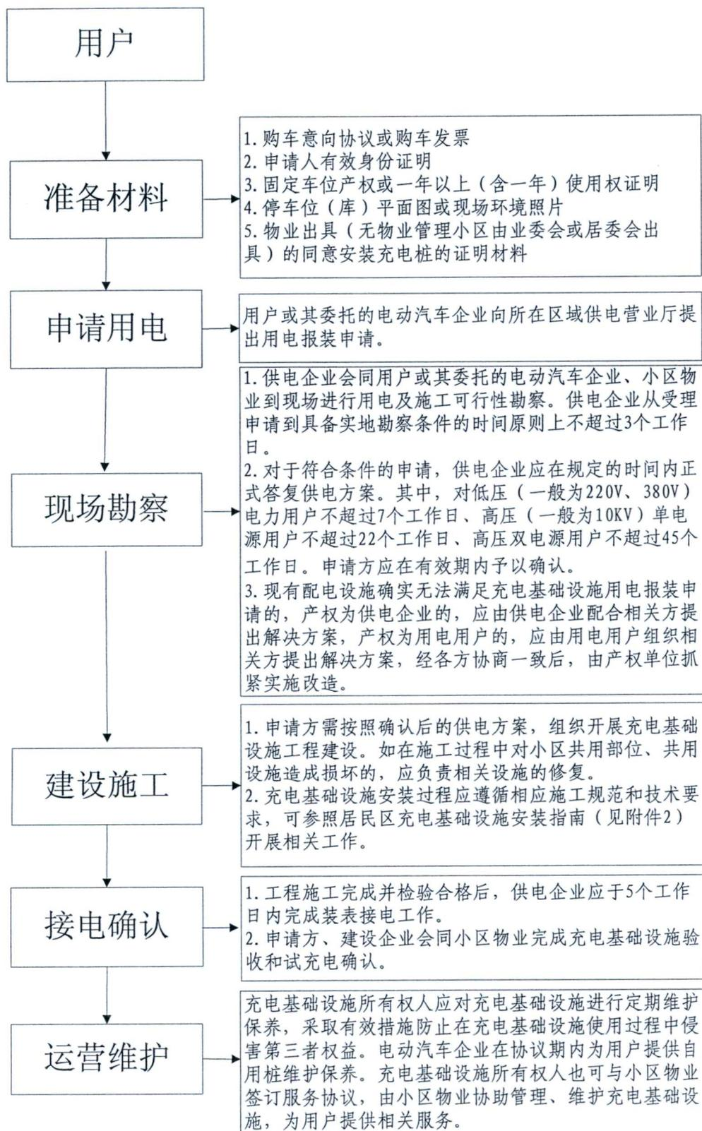
图 1 自用桩建设管理流程图
