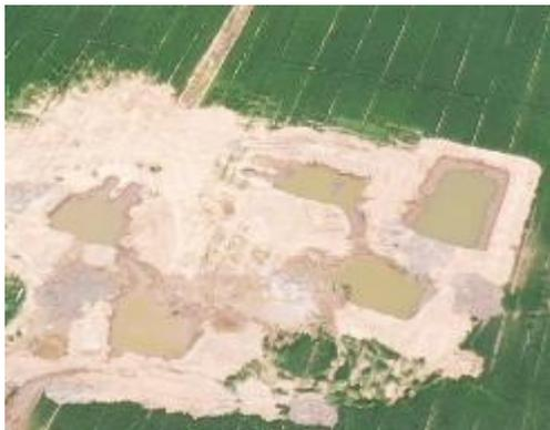
塔基及塔基施工区 泥浆沉淀池
